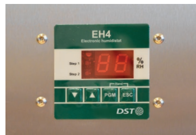
EH4 monterad i avfuktare typ R-61R
